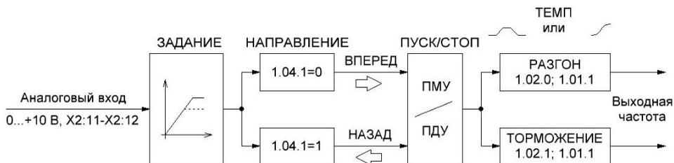
Рисунок 12 – Структура выработки задающего воздействия на выходную частоту преобразователя в режиме 1
