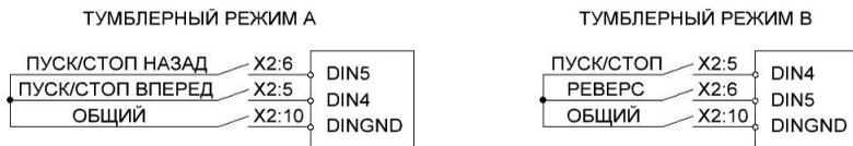
Рисунок 17 – Внешние соединения при тумблерных режимах дистанционного управления преобразователем частоты
